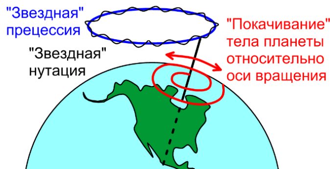
Рис. 1. Колебания оси вращения Земли относительно звезд и тела планеты (по [9] с дополнениями)
